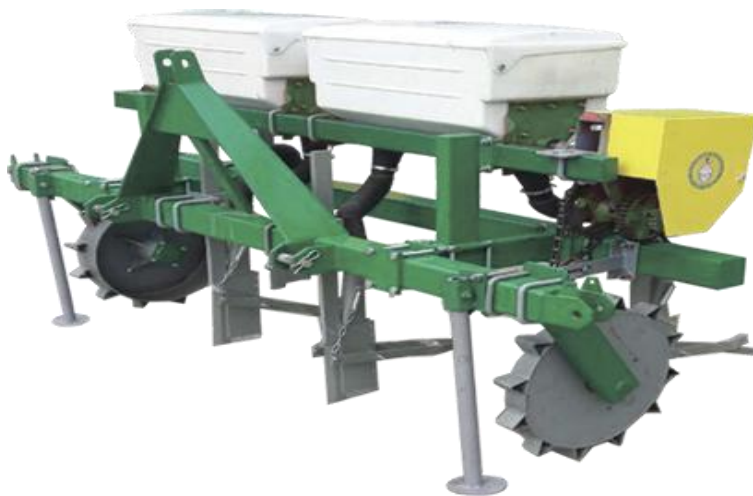
Рис.1 - Агрегат для внесения удобрений АВУ- 4 (без устройства для укладки трубки капельного орошения). Вид общий
