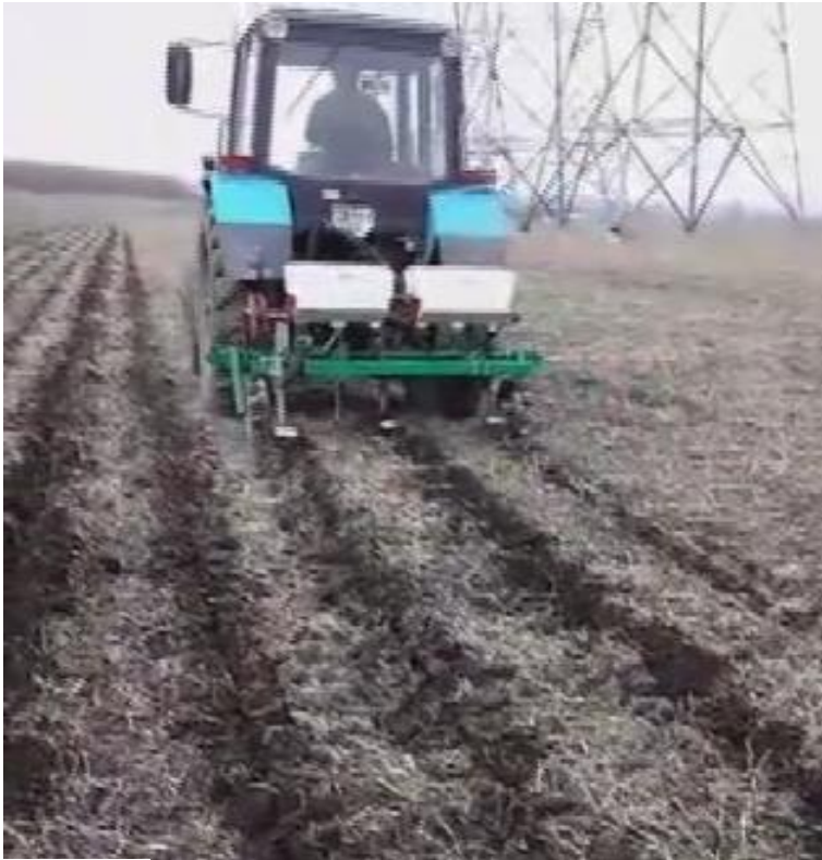
Рис. 3 - Агрегат для щелевания и внесения удобрений АБУ- 4 в работе.
